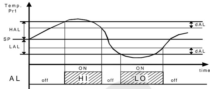
Las alarmas de temperatura de máxima y mínima se pueden desactivar programando los parámetros "HAL" y "LAL" = OFF. A la vez que salta la señal de alarma configurada (buzzer y/o salida), el led AL se enciende, se apaga el led OK, se enciende el led - en caso de alarma de mínima o el led + en caso de alarma de máxima y se visualiza sobre el display:
