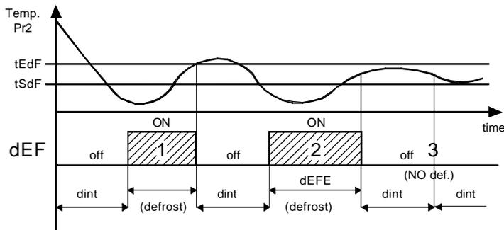
**Ejemplo:** el descarche 1 termina cuando se alcanza la temperatura "tEdF", el descarche 2 termina cuando se alcanza el tiempo "dEFE" si no se alcanza la temperatura "tEdF", el descarche 3 no se efectúa ya que la temperatura es superior a "tSdF".
