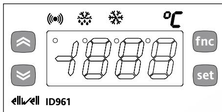
Al encenderse el instrumento se realiza un Chequeo de Pilotos; durante algunos segundos el display y los leds parpadean, comprobando la integridad y buen funcionamiento de los mismos. El instrumento dispone de dos Menús principales, el Menú del "Estado de máquina" y el Menú de "Programación".
