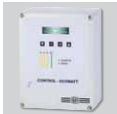
CONTROL ECOWATT AC/4A Elemento de control para sistemas de modulación de los caudales en instalaciones de ventilación de edificios públicos, comerciales o residenciales, que controla continuamente la velocidad de los motores para adecuarse a las necesidades reales, reducir el consumo energético y mantener un ambiente bien ventilado.
