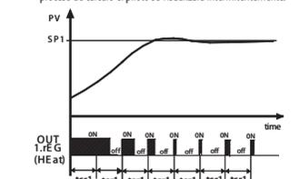
IMPORTANTE: Para realizar el cálculo Autotuning tiene que haber una gran diferencia entre SP1 y el valor de la sonda.
