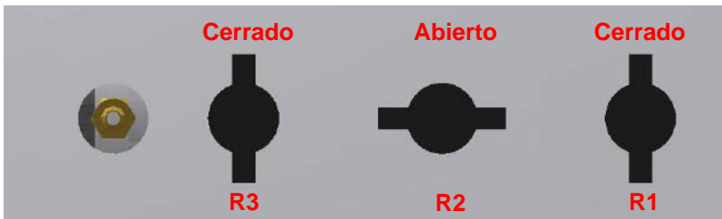
Figura 1. Posición correcta llaves para lavado de instalaciones
