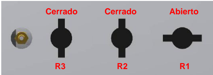
Figura 2. Posición correcta de las llaves para el flushing standard
